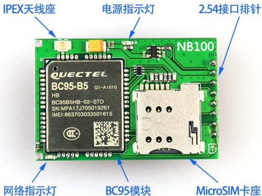
CAD 尺寸和接口描述如下。整个模块尺寸仅 30mm\*45mm，采用 2.54 排针引出常用信号。
